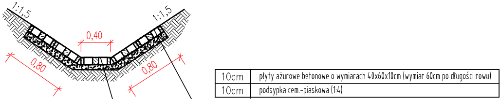
SZCZEGÓŁ NR 2 UMOCNIENIE DNA I SKARP ROWU BETONOWYMI PŁYTAMI AŻUROWYMI W MIEJSCACH ZGODNIE Z TABELĄ ROWÓW
